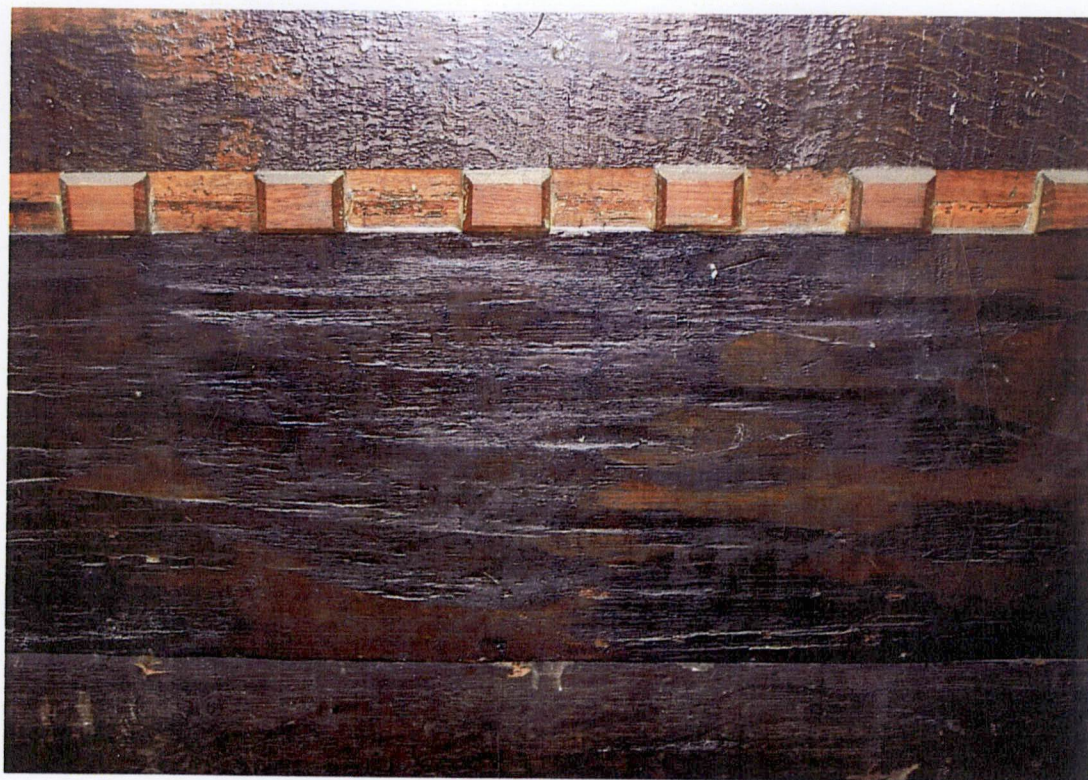
Fig.63. Traces d'une égalisation à la plane (Ypres.B.3).
