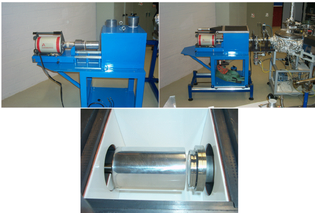
Figure 23 – Photos montrant le châssis, sur roulements à billes, sur lequel se trouve le château de plomb ainsi que le détecteur HPGe, lui aussi sur roulement à billes. Sur la deuxième photo, il a été glissé à l'intérieur du château, très proche du porte-échantillon, comme montré sur la troisième photo.
