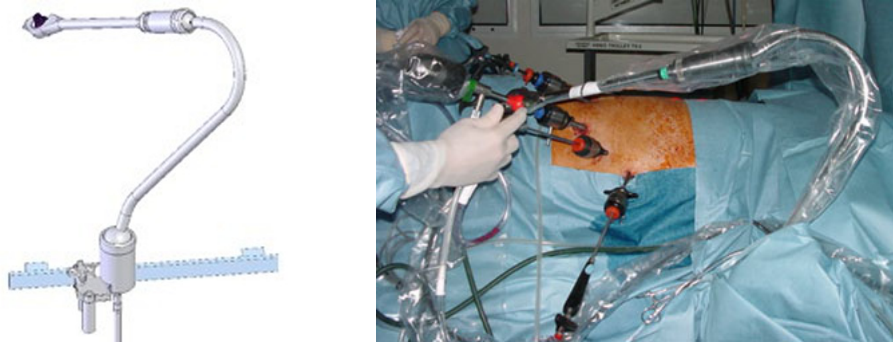
FIGURE 1.6 – Porte-endoscope passif Endoboy (Geyser-Endobloc), fixé sur un rail latéral de la table d'opération (source : www.geyser-endobloc.fr )
