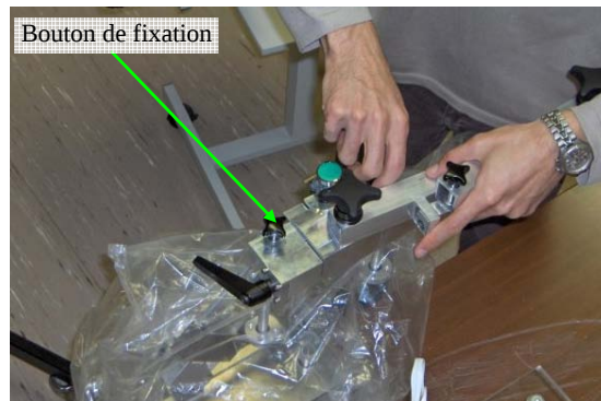
Fig. 3. Fixation du bras sur la nacelle.
