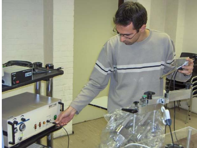
Fig. 5. Raccordement du cordon d'alimentation du zoom.
