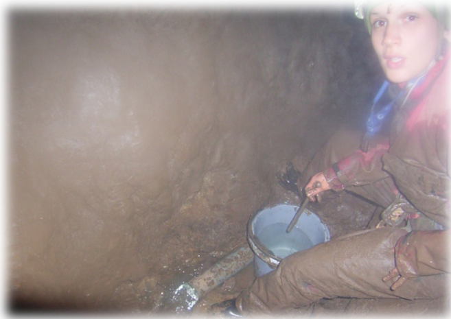
15. Mesure du débit par empotement de la rivière de la grotte du PN
