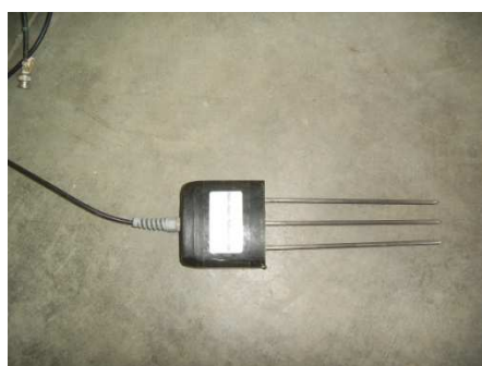
Figure 7 : Sonde TDR à 3 broches utilisée lors de nos expériences.
