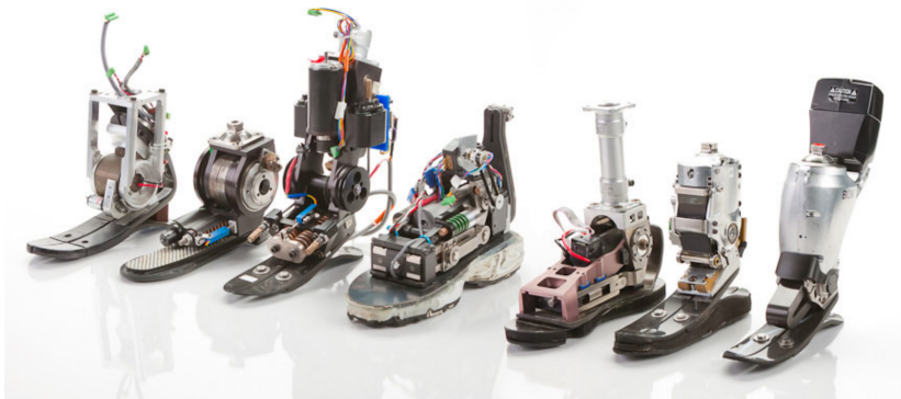
Fig. 2.12: Ankle-foot prostheses developed at the MIT [20].
