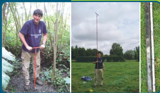
Forages manuels à la tarière jusqu'à max. 6 m.
