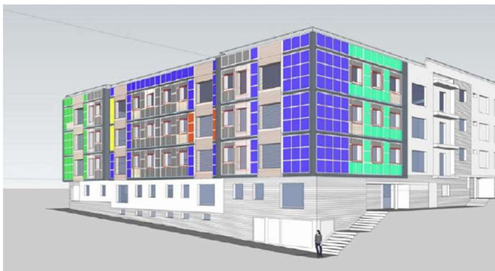
Système MEEFS appliqué sur un bâtiment démonstrateur à Merida, Espagne, in MEEFS : 2nd Reporting Period Publishable Summary on Progress, 27-02-15
