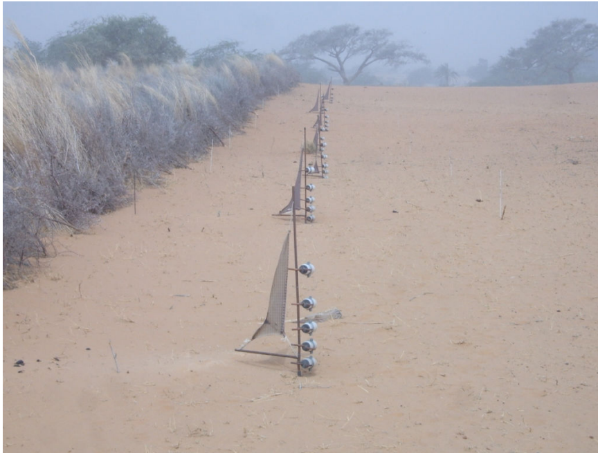
Figure 7-2: Capteurs de sédiments (MWAC) installés à 3 m au vent par rapport à la première palissade de Leptadenia pyrotechnica sur la dune rive de Tchago
