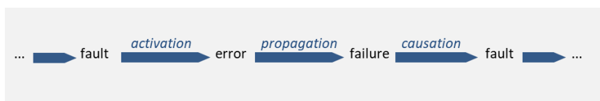
Figure 6-2 – Relation faute-erreur-défaillance (Avizienis et al., 2001)
