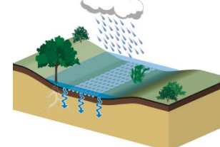
Noue engazonnée infiltrante renforcée
