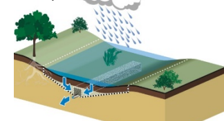
Noue infiltrante avec enrochement linéaire au point bas
