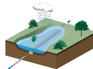
Bassin sec à cunette
