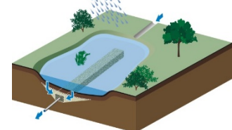
Bassin sec à enrochement avec évacuation à débit régulé
