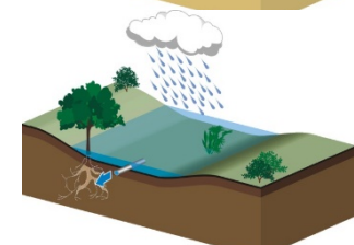
Noue à évacuation superficielle
