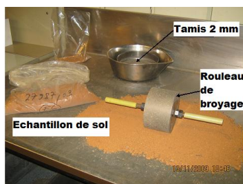
FIGURE 6.2 – Broyage d'un échantillon de sol
