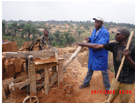
FIGURE 2.5 – Moule de compactage semi-artisanal dans la carrière de Sanguluja
