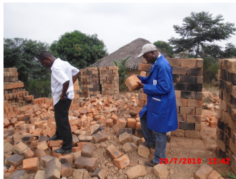
FIGURE 1.1 – Incuits après une cuisson artisanale des briques à Muene-Ditu
