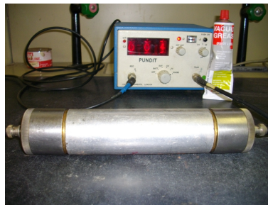
FIGURE 7.8 – Mesures ultrasoniques avec transducteurs en formes de disques sur le cylindre étalon
