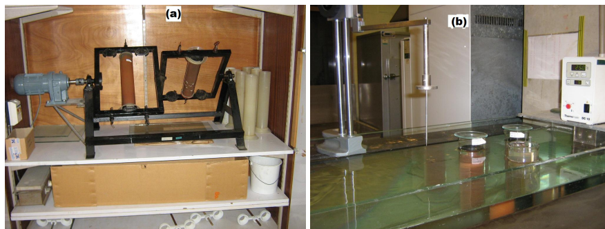
FIGURE 4.3 – Agitation de la solution défloculée (a) et sédimentation (b) des sols (photos LEMSC)
