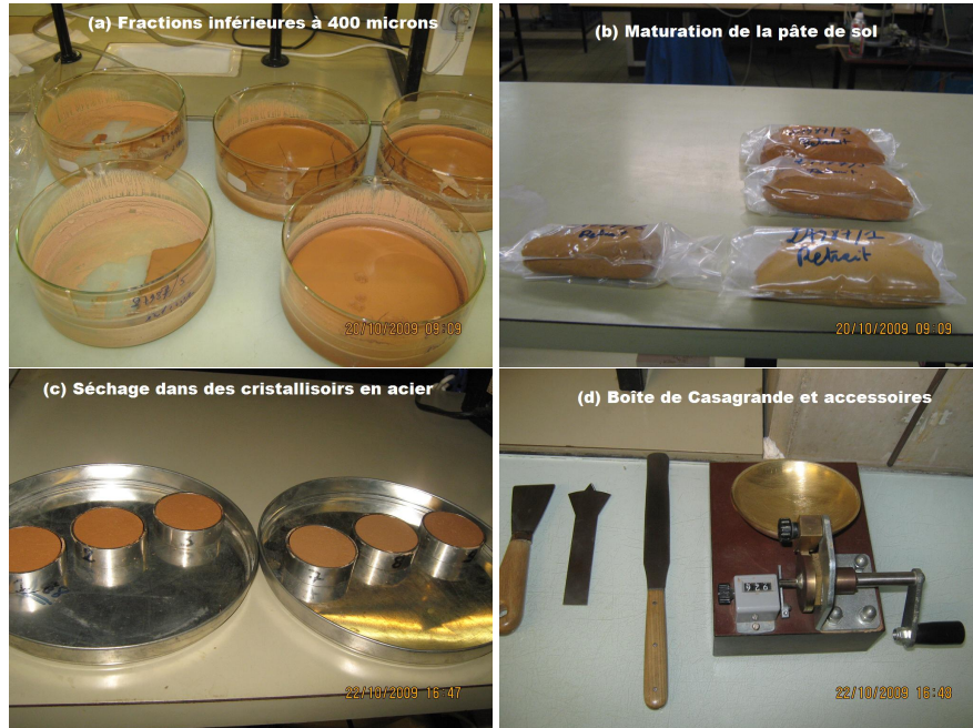
FIGURE 4.7 – Détermination des limites d'Atterberg (photos LEMSC)
