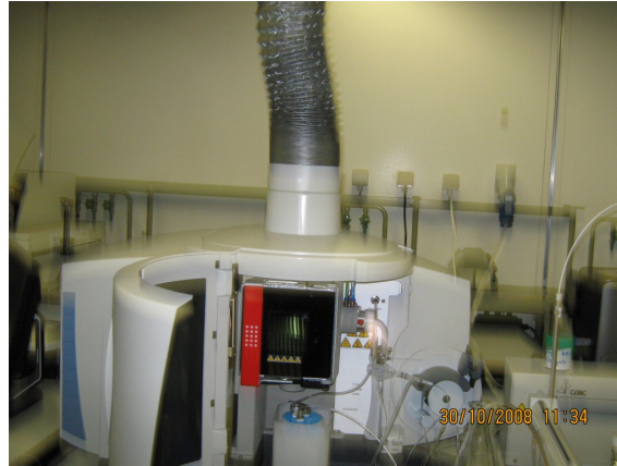
FIGURE 4.16 – Vue d’un appareil de spectrométrie ICP (photo SOLS)
