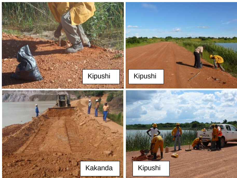
Figure IV-3: Prélèvement des échantillons sur les plates-formes des digues
