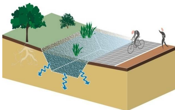
Figure 75 - Tranchée remplie de structure granulaire de type "gravier" sans couche superficielle particulière : le gravier reste apparent à la surface du jardin. L'eau est acheminée en surface depuis les surfaces de ruissellement adjacentes à la tranchée. Source : Architecture & Climat.
