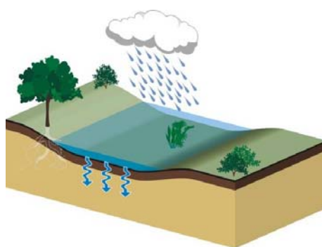
Figure 31 - Schéma de principe d'une noue infiltrante qui se remplit temporairement d'eau de pluie au moment d'un orage : il s'agit d'une dépression de sol engazonnée qui permet l'infiltration de l'eau dans le sol, son évaporation vers l'atmosphère et évapotranspiration par la végétation (plantations et gazon). Illustration : Architecture & Climat.
