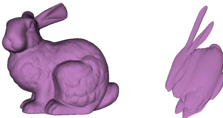
FIG. 3.11 – Exemple de maillage exagérément lissé. A gauche : original (données : Stanford 3D Scanning Repository). A droite : maillage lissé.
