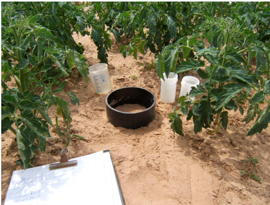
Fig. 5.8: Réalisation d'un essai d'infiltration à charge nulle (Beerkan).
