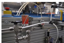
Figure C.23: Position de la vanne d'arrivée d'argon.
