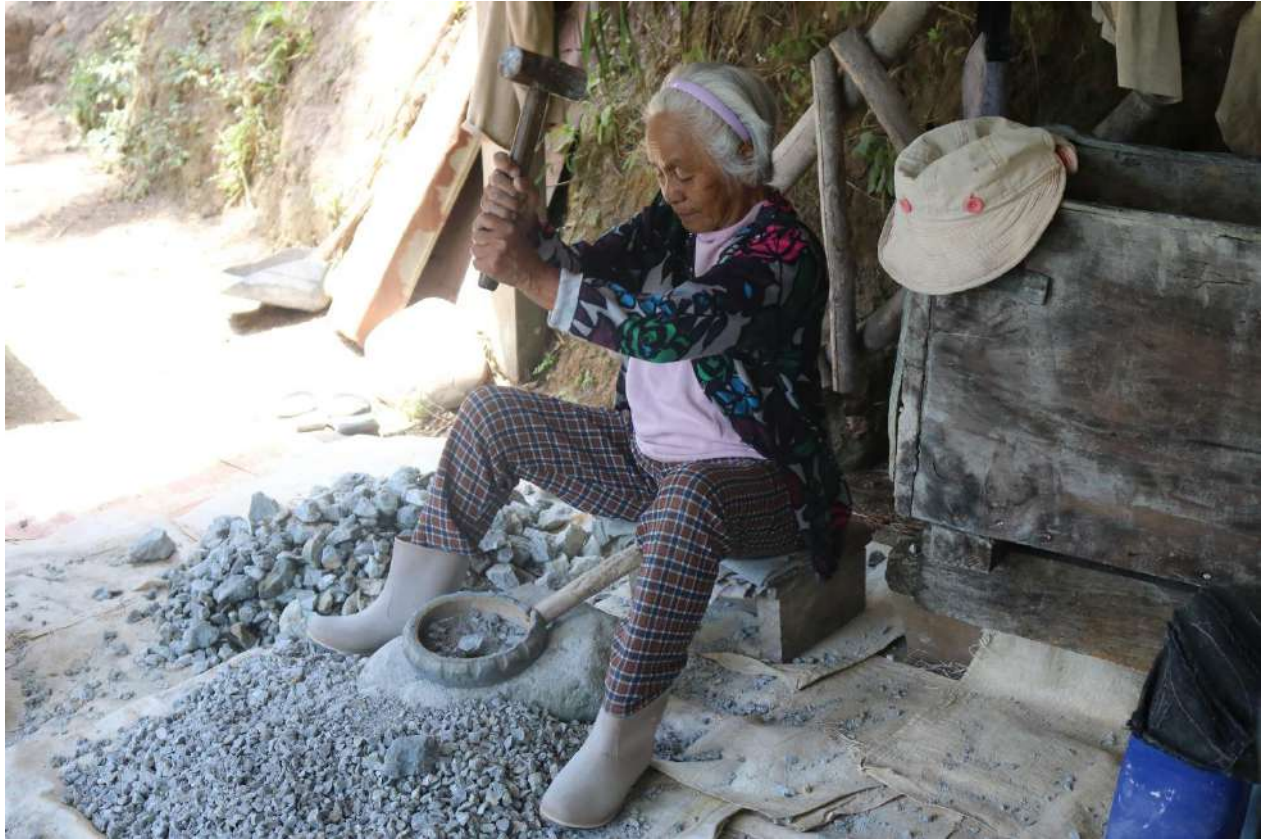
Figure 148. Lola Tarcela, assise sur un shitmog , réduit des pierres contenant de l'or à l'aide d'un maillet. Kalabkaben, mars 2020.
