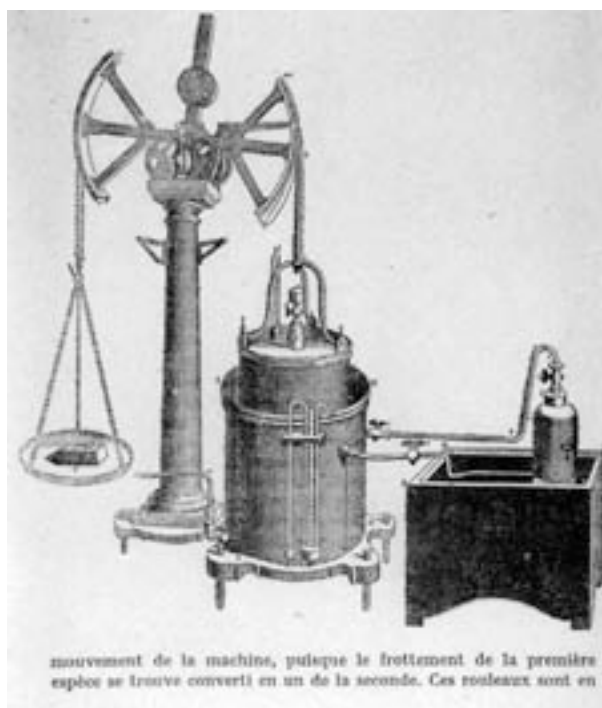
Lavoisier : Description des appareils pneumato-chimiques (figure 18 du Traité élémentaire de chimie , 1789). La méthode de pesée et de bilan pondéral dans l'étude des réactions chimiques de Lavoisier lui a permis de formuler la loi de conservation de la matière, qui est à la base de tout traitement rationnel des réactions chimiques. Dans son Traité élémentaire de chimie publié en 1789, il précise : « Rien ne se crée, ni dans les opérations de l'art, ni dans celles de la nature, et l'on peut poser en principe que dans toute opération, il y a une égale quantité de matière avant et après l'opération, que la qualité et la quantité des principes est la même, et qu'il n'y a que des changements, des modifications ». Photo Jozeph Goossens.
