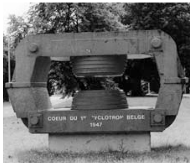
Culasse de l'aimant du premier cyclotron belge, au Boulevard Baudouin I er . C'est en 1947 que fut lancé à l'Université catholique de Louvain le projet de construction d'un cyclotron conçu par le professeur Marc de Hemptinne dès avant la guerre. L'électroaimant fut installé en janvier 1951 dans le nouveau bâtiment de l'Institut de physique nucléaire construit dans le Parc d'Arenberg. Il se trouve actuellement comme monument sur la berme centrale du « boulevard Baudouin I er », après avoir travaillé comme accélérateur jusqu'en juin 1971. Photo Fondation wallonne P.-M. et J.-F. Humblet.
