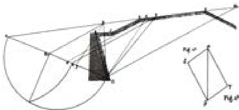
Fig. 4.3 : étude graphique de la poussée des terres chez Poncelet , d'après Fritz Kötter : Die entwicklung der Lehre von Erddruck in Maurer [1998], p. 112 Fig. 51
