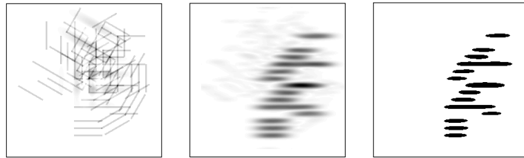
FIGURE 22 – Filtrage directionnel avec une ondelette conique : (a) Le signal ; (b) La TO ; (c) La TO après seuillage (d’après [4, Sec.14.3.2]).
