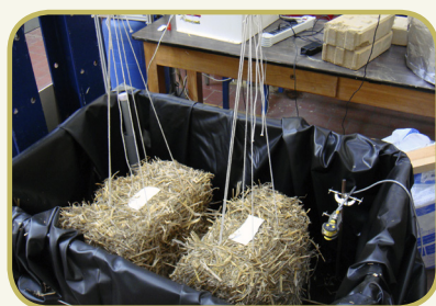
Fig. 19 : Absorption capillaire sur des échantillons de ballot de paille.
