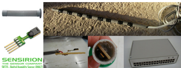
Fig. 73 : Chaine de capteurs développée et installée au sein des parois en paille.
