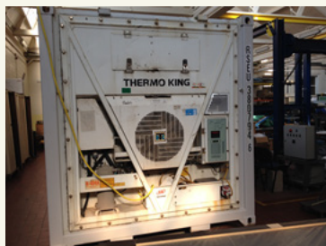
Fig. 37. Chambre climatique destinée à accueillir la plaque chaude gardée dans une ambiance contrôlée à 10 °C.
