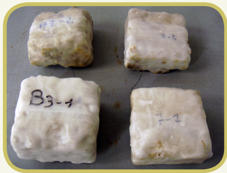
Fig. 13: Echantillons d'enduit paraffinés.
