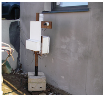
Fig. 74a: Station météo et acquisition des mesures à Tongrinne, avant les enduits extérieurs.
