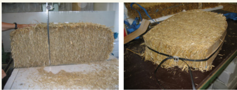
Fig. 40 : Echantillon utilisé pour les mesures de conductivité thermique en Allemagne (FIW).
