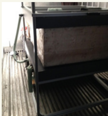
Fig. 38: La plaque chaude gardée et l'écran de contrôle.
