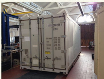
Fig. 37. Chambre climatique destinée à accueillir la plaque chaude gardée dans une ambiance contrôlée à 10 °C.
