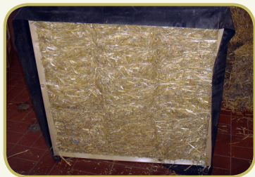
Fig. 28 : Cadre de paille testé sur la plaque chaude gardée.
