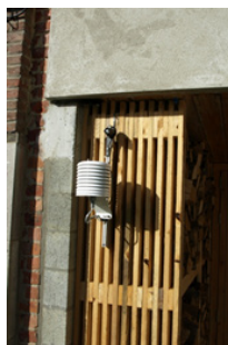
Fig. 74a: Station météo et acquisition des mesures à Tongrinne, avant les enduits extérieurs.
