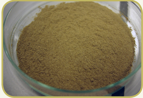
Fig. 15 : Echantillon d'enduit broyé et séché et de paille broyée et séchée.
