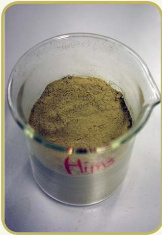
Fig. 15 : Echantillon d'enduit broyé et séché et de paille broyée et séchée.
