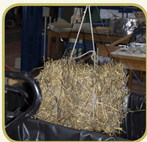
Fig. 22 : Essais de la teneur en eau à saturation libre sur 1/3 de ballot de paille.
