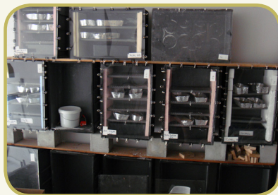
Fig. 24 : Enceintes climatiques utilisées pour les essais sur enduits.
