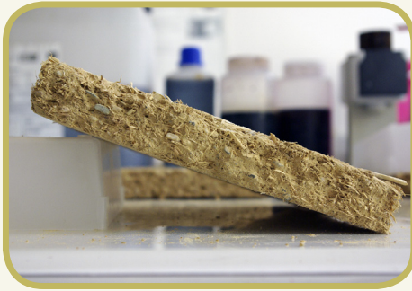
Fig. 18 : Echantillon d'enduit avant essai.
