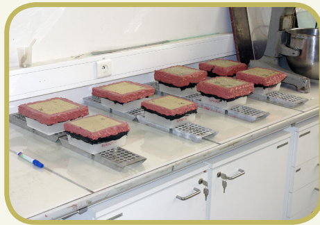
Fig. 16 : Essai de perméabilité à la vapeur sur enduits.
