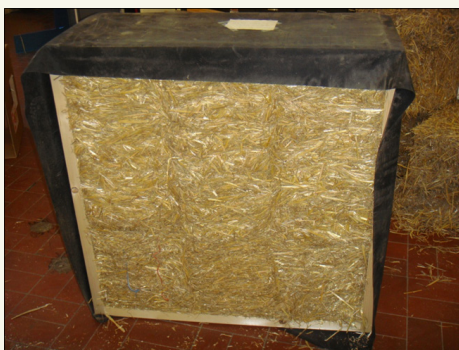
Fig. 36 : Echantillon type : 3 ballots de caractéristiques identiques sont placés dans un cadre en bois, lui-même entouré d'une membrane d'étanchéité.
