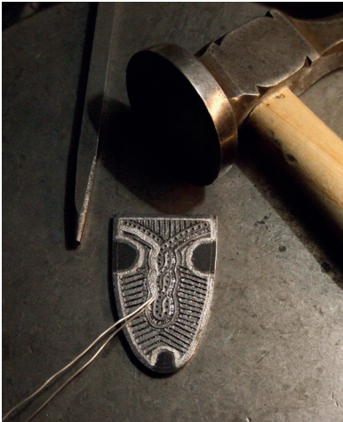
Reproduction d'une damasquinure. Réalisation et photo L. De Vos.
