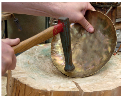
Déformation expérimentale d'une tôle par défonce, avec un marteau à emboutir. Photo L. Saussus.
