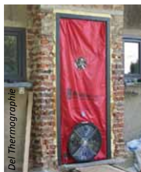
A gauche : Infiltrations d'air fréquentes dans les bâtiments. A droite : Test blower door - côté extérieur et intérieur.
