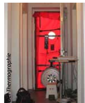
A gauche : Infiltrations d'air fréquentes dans les bâtiments. A droite : Test blower door - côté extérieur et intérieur.
