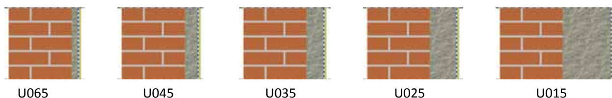
Différents niveaux de performances thermiques pour un mur isolé avec des fibres de cellulose.
