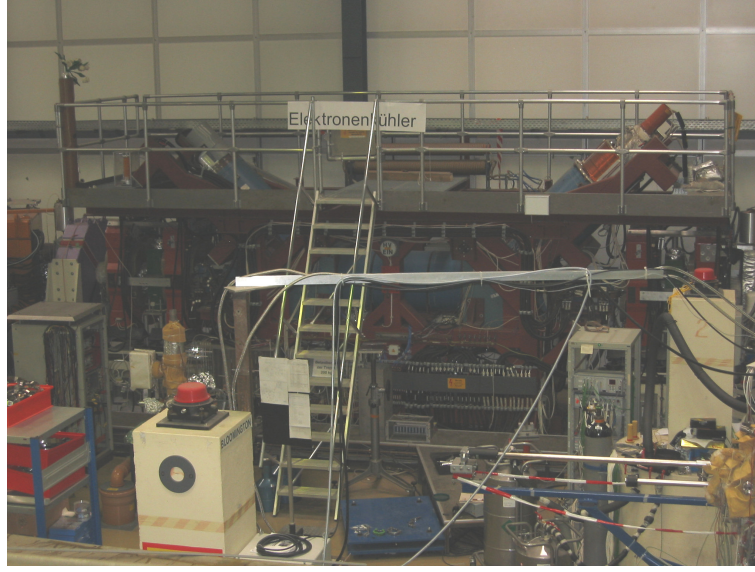
FIG. 7.6 – Photo de l'électron cooler.
