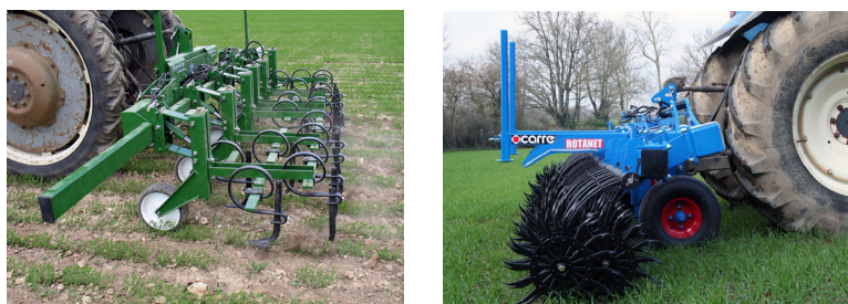
Fig. 58 : Exemple d'une bineuse (à gauche) et d'une houe rotative (à droite) utilisées pour le désherbage mécanique des céréales. (Source : direct-affaires.fr).
