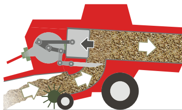
Fig. 32 : Principe d'acheminement de la marchandise dans la chambre de compression de la presse « Massey Fergusson » (Série 1800). (Source : www.masseyferguson.com ).
