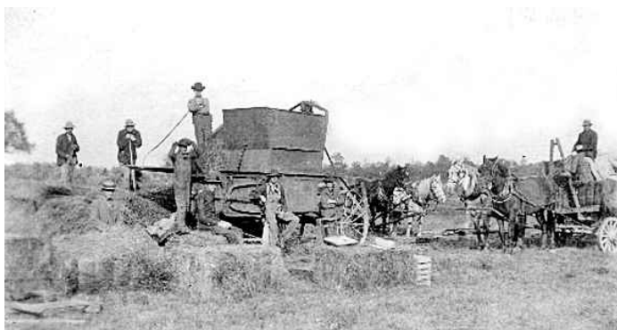
Fig. 1 : Un exemple des premières presses agricoles stationnaires - 1908. Les rendements de l'époque étaient excessivement mauvais ; il fallait compter plusieurs heures pour la réalisation d'un ballot contre 1 à 2 minutes à peine pour les modèles actuels. (Source : http://www.cardington-ohio-heritage.com/ )
