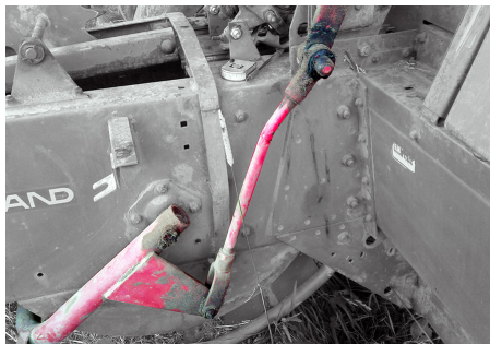
Fig. 44 : Principe d'entraînement des aiguilles. Au déclenchement des noeuds, le système induit une rotation des aiguilles à travers le canal de compression. (Photographie : B. Biot - ICEDD).
