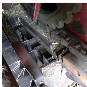
Fig. 40 : Vue rapprochée du piston par le dessus. Le couteau est situé sur le côté visible du piston. (Photographie : B. Biot - ICEDD).
