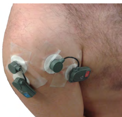
Fig. 10.4 – Placement des EMG sur le deltoïde médian et antérieur d'un sujet.
