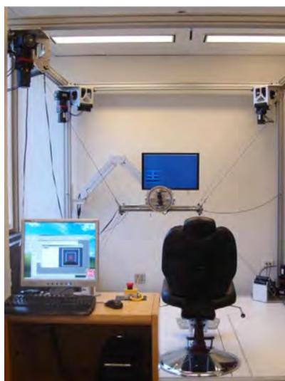
Fig. 1.8 – Vue du robot à effecteur à câbles MACARM [20] et principe du mode d'action dans le plan sagittal.
