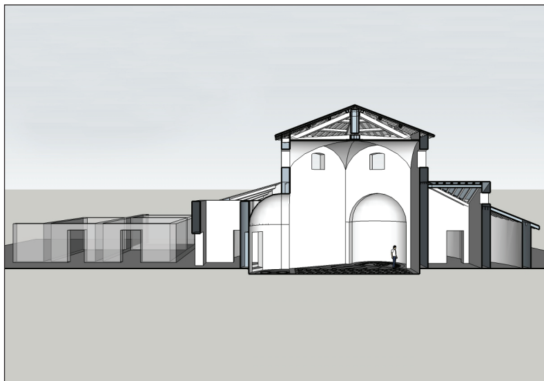
FIGURE 9 : Reconstitution en coupe hypothétique de la salle trilobée, calculée sur base des relevés architectonique et d'un calcul structurel (conception graphique M. Bertoni).
