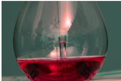
Figure 2 : Le petit tube de verre qui lie les deux compartiments de l'ébulliomètre.
