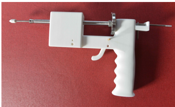
Fig. 3. Maquette imprimée en 3D du futur dispositif de résection : un cône métallique (à gauche) permet le blocage et la découpe de la valve.
