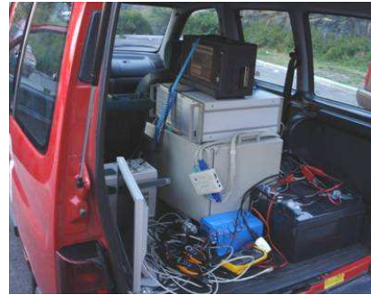
(d) Measurement equipment in the Rx trunk.
