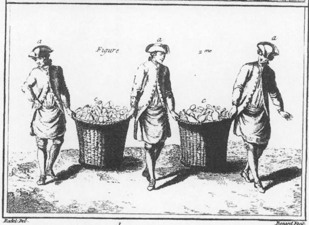
Verrerie en bois, opération de retirer de l'âtre les verreries remplies de différentes marchandises de Verrerie pour les porter au Magasin.
