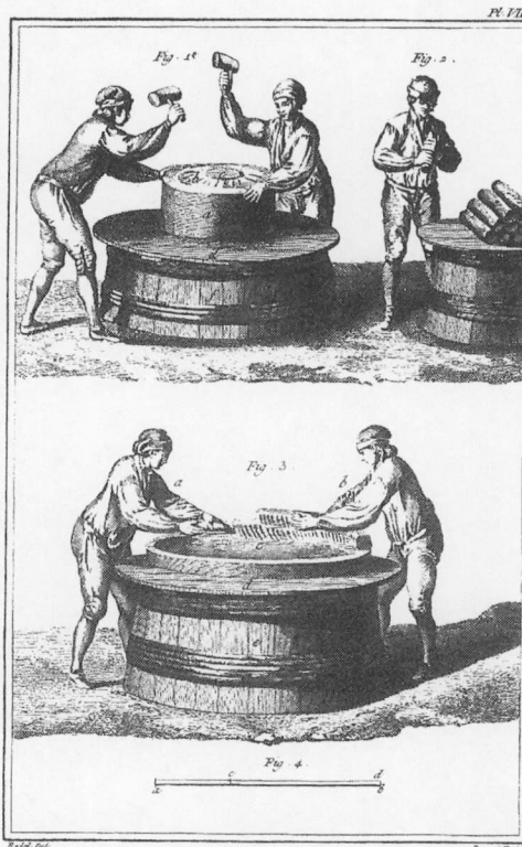
Verrerie en bois, Différentes Opérations pour la formation d'un Pot de petite Verrerie à Pavée.
