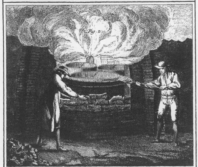
Verrerie en bois, l'opération de transporter les Pots de la Carcasse au Four, et l'opération de fermer la grande ouverture du Four avec de la terre glaise contenue par le Bonhomme.
