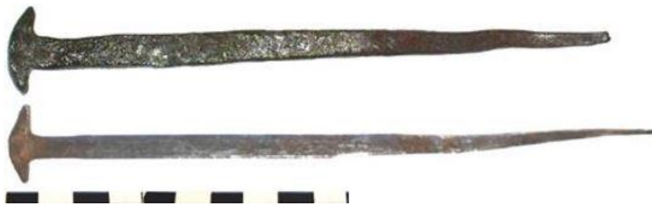
Fig. 17. Wavy edged Sparrennagel, 1500-10 d, Beutelsbach, and straight edged Aufschiebling nagel, circa 1750, Schloss Wolfegg, Oberschwaben. Author.
