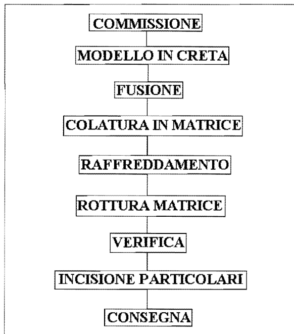
Fig. 10 – Diagramma di flusso della successione cronologica delle operazioni per la creazione di una scultura bronzea presso un'officina del Sud dell'India.
