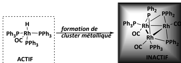
Figure 30 : Formation d'un cluster métallique inactif dû à la décomposition thermique des ligands triphénylphosphine.
