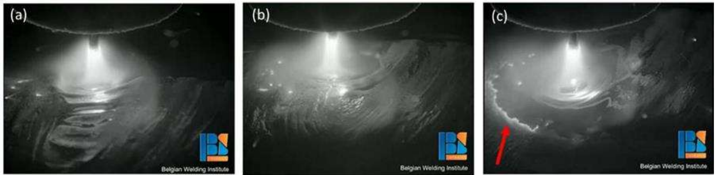
Foto 2: Gebruik van een thermische camera om de vorming van kathodische punten tijdens het WAAM-proces te observeren
