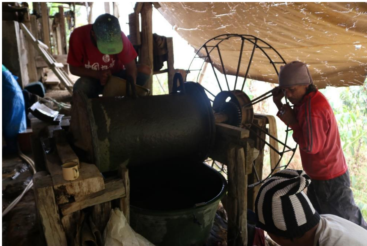
Figure 74. Le broyeur à boulet posipos . Kalabkaben, mars 2020.
