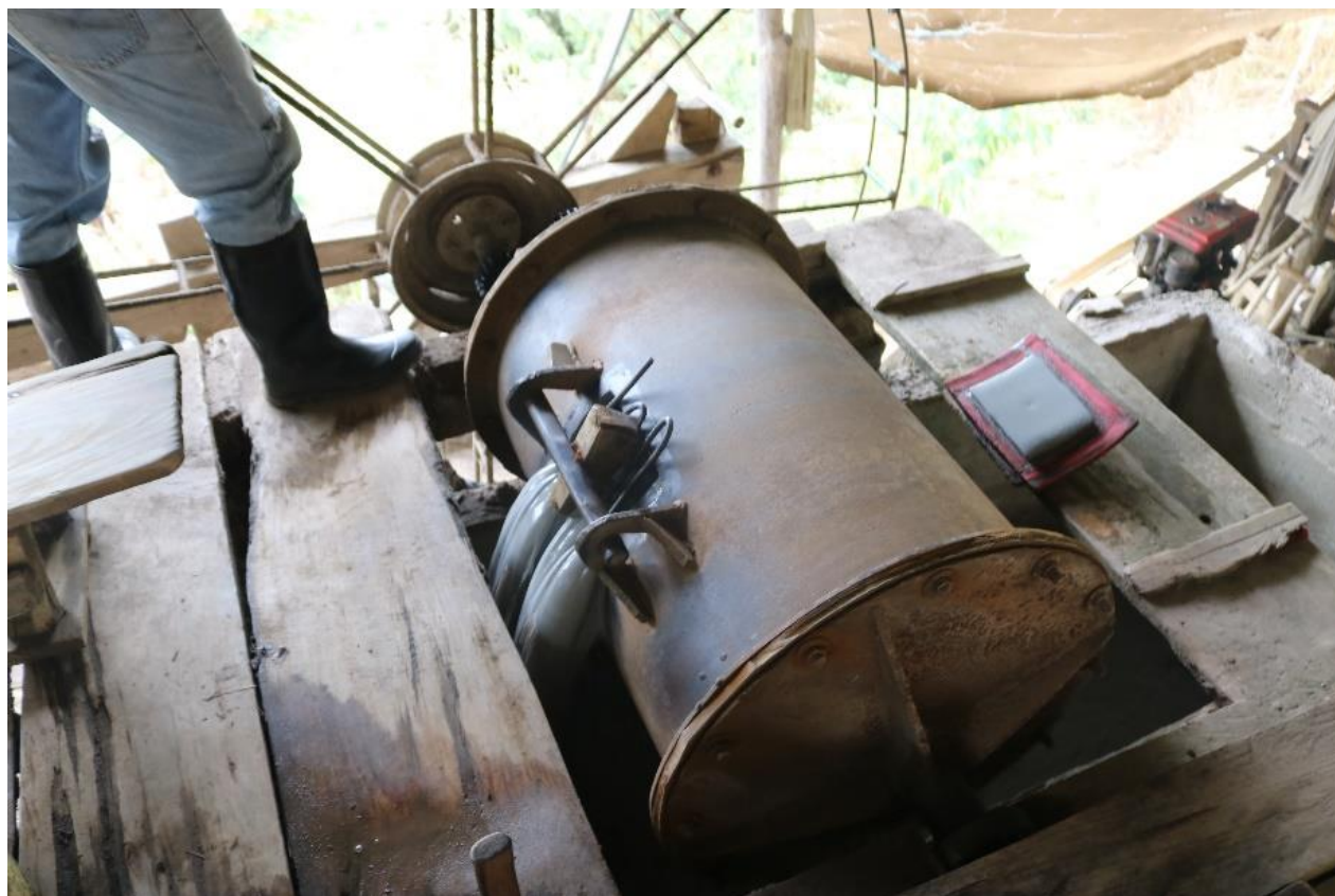
Figure 73. Le broyeur à boulet kiling . Kalabkaben, mars 2020.
