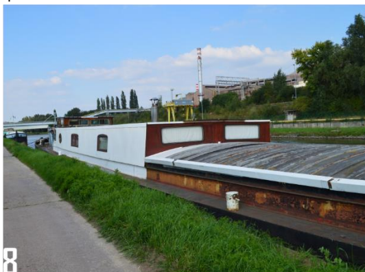
(4)(8) Superstructures fraîchement repeintes, laissées dans la couleur de l'antirouille pour l'une (5) tandis que les hiloires de l'autre (8) sont fortement rouillées.
