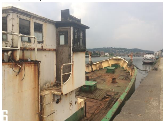
(3)(6)(7) La présence importante de rouille, de mousse, de peinture écaillée,... fait penser que ces bateaux ne sont pas entretenus ou habités (ce qui n'est pas nécessairement le cas).
