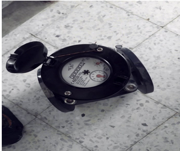
Figure 22 : Un modèle de compteur d'eau mis en place dans un périmètre irrigué modernisé de la Manouba
