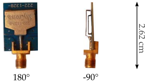
FIGURE 4.2 – Profil de l’antenne Skycross sous des angles azimutaux valant 180^\circ et -90^\circ .
