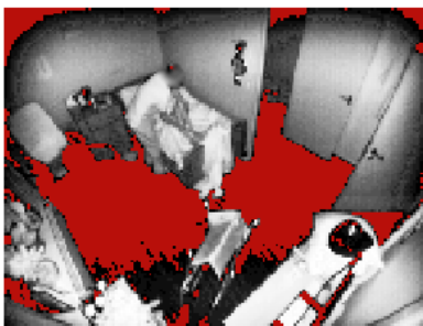
FIGURE 4 – Cas d’erreur : la lumière réfléchi par le revêtement du sol perturbe la ToF. En rouge, nous voyons les points pour lesquels la ToF ne fournit aucune mesure de distance et qui ne servent donc pas pour la calibration du sol.
