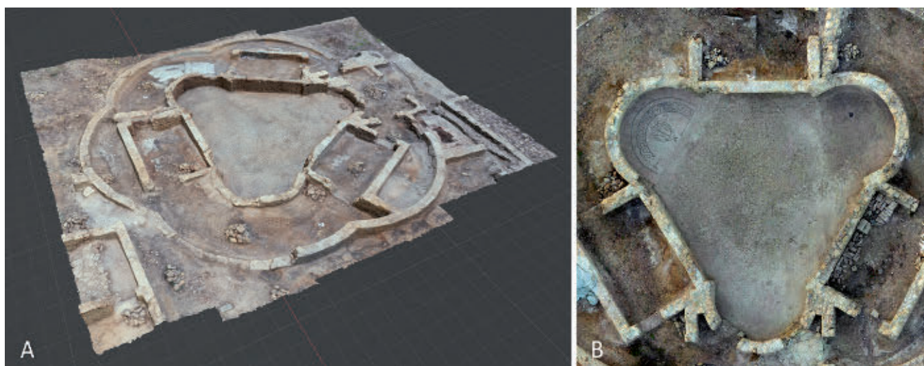
FIG. 93. Modello tridimensionale della Sala triabsidata ottenuto con tecniche fotogrammetriche. A) visualizzazione del modello con texture che ne definisce la superficie; B) ortofoto ad alta risoluzione della sala (foto D. Ferdani, 2018).
