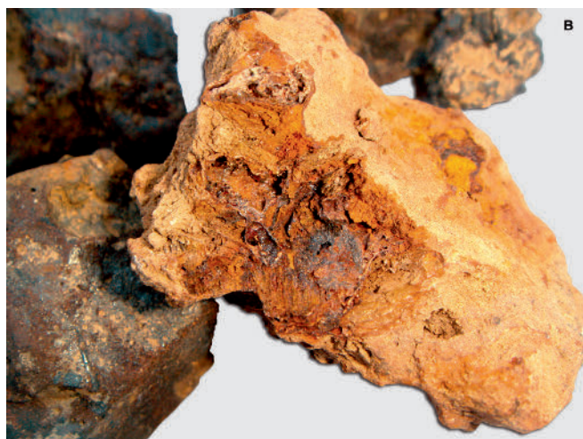
FIG. 146. Scorie di lavorazione del ferro al momento del rinvenimento (A) e sezionate per le analisi in laboratorio (B) (foto di A. Giunilia-Mair, 2009).
