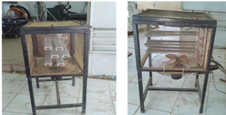
Figure III. 6 : Banc de charges résistives
