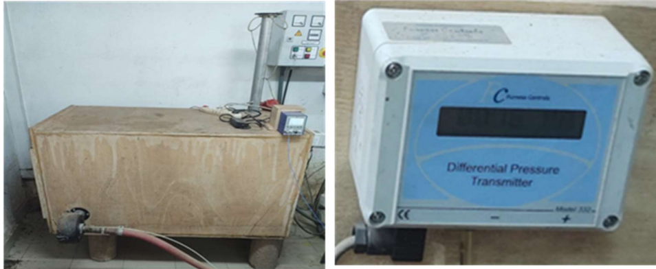
Figure III. 4 : Système de mesure du débit d'air : À gauche le caisson d'air et à droite le capteur
