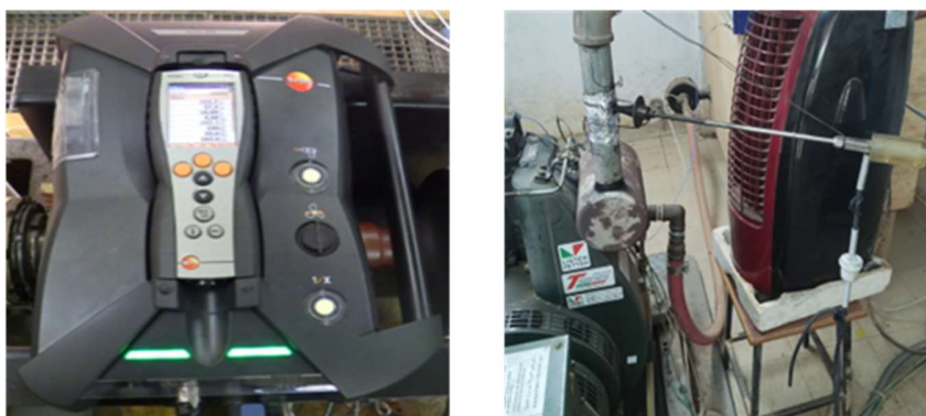
Figure III. 8 : Analyseur de gaz de combustion Testo 350 à gauche et la sonde de prélèvement à droite
