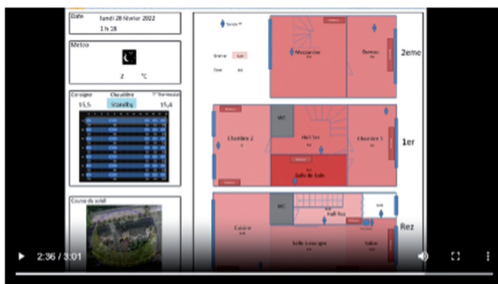
△ Figure 46. Distribution spatiale des températures dans la maison mitoyenne d'un-e cochercheur-euse, février 2022.
