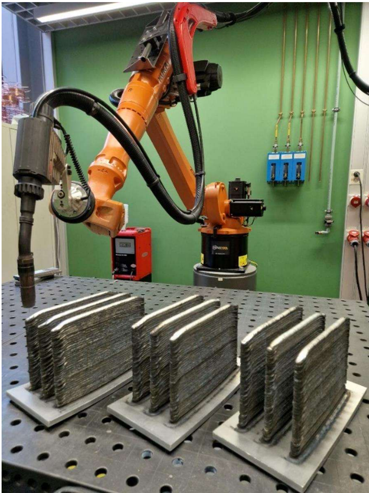
Foto 1: Aluminium werkstukken in de legering ER 5183 vervaardigd via WAAM, voor mechanisch en metallurgisch onderzoek
