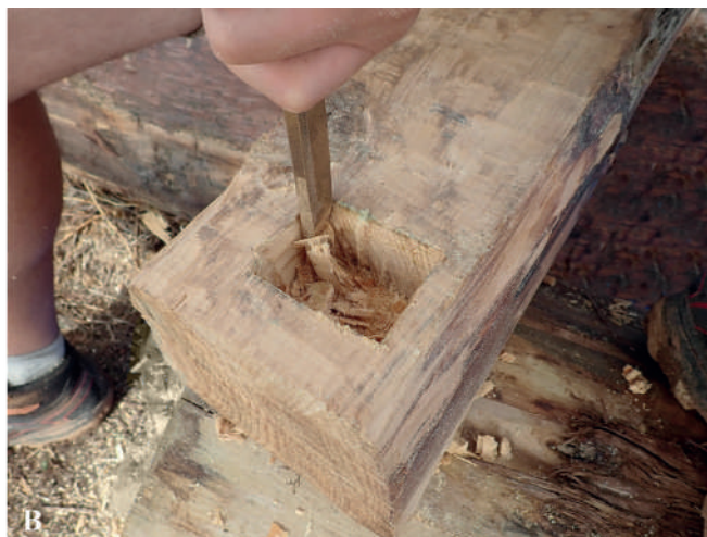
Fig. 5b. Creusement d'une mortaise quadrangulaire dans une traverse. Travail au marteau et aux ciseaux en bronze (V. Loescher/ TiMMA).
