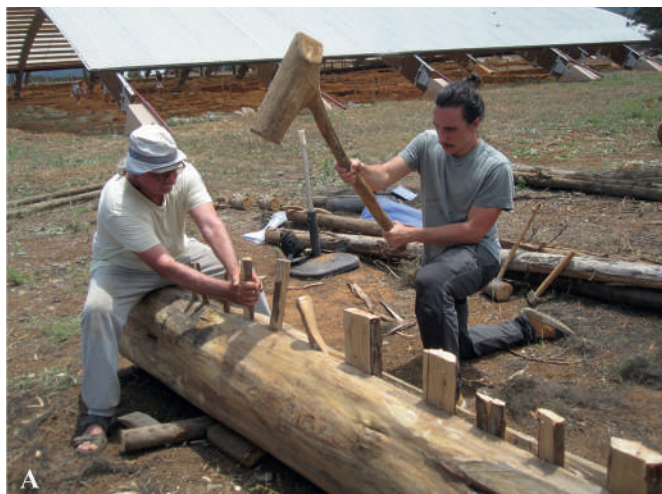
Fig. 5a. Travail de refente en demi-rondin d'une grume de cyprès d'environ 50 cm de diamètre. Le travail d'amorce aux coins en bronze est terminé. La refente est conduite à l'aide de coins et d'une masse en bois (P. Bacoup/ TiMMA).
