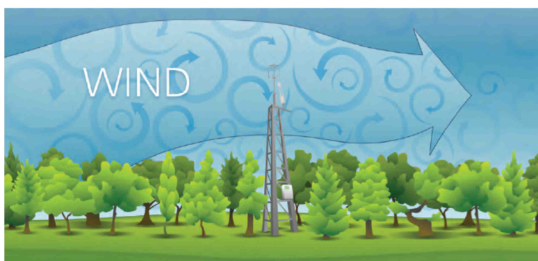
Figure 1.3 : Représentation de la turbulence (tourbillons) mesurée par le système d'eddy covariance au sommet de la tour en fonction de la direction et de la vitesse du vent (wind). Issu de Burba (2013).
