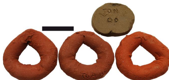
Figure III.78 : Argile crue de la Fm de Borgloon, Mb de Alden Biesen (haut droite), et colombins de l'échantillon Ton-06.a cuits en atmosphère oxydante à 700°C (gauche), 800°C (centre) et 900°C (droite). Echelle : 2 cm.
