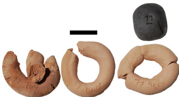
Figure III.123 : Argile crue de la Fm de Aachen (haut droite), et colombins de l'échantillon 123W0287d cuits en atmosphère oxydante à 700 (gauche), 800 (centre) et 900°C (droite). Echelle : 2 cm.
