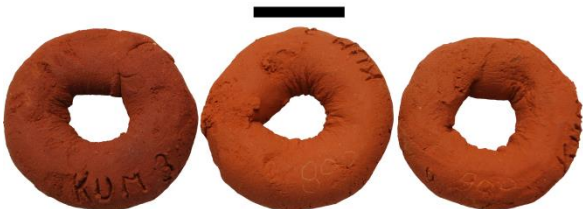
Figure III.66 : Colombins de l'échantillon Kum-03.a cuits en atmosphère oxydante à 700°C (gauche), 800°C (centre) et 900°C (droite). Echelle : 2 cm.
