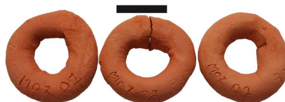
Figure III.106 : Colombins de l'échantillon TR-01.a cuits en atmosphère oxydante à 700°C (gauche), 800°C (centre) et 900°C (droite). Echelle : 2 cm.
