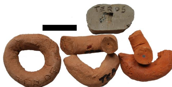
Figure III.55 : Argile crue de Boom, Fm de Boom, Mb de Terhagen (haut droite), et colombrins de l'échantillon Ter-05.a cuits en atmosphère oxydante à 700°C (gauche), 800°C (centre) et 900°C (droite). Cet échantillon illustre bien les problèmes d'oxydation de la pyrite (centre). Echelle : 2 cm.
