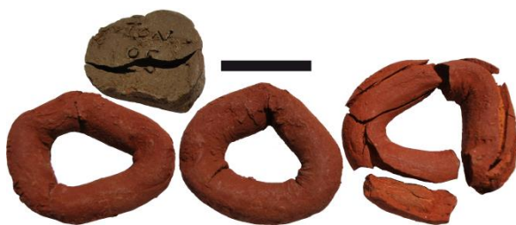
Figure III.77 : Argile crue de la Fm de Borgloon, Mb de Alden Biesen (haut), et colombins de l'échantillon Ton-05.a cuits en atmosphère oxydante à 700°C (gauche), 800°C (centre) et 900°C (droite). Echelle : 2 cm.
