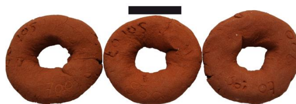
Figure III.146 : Colombins de l'échantillon Soi-07.a cuits en atmosphère oxydante à 700°C (gauche), 800°C (centre) et 900°C (droite). Echelle : 2 cm.
