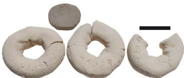
Figure III.116 : Argile crue d'Hautrage (haut droite), et colombins de l'échantillon Hau-07.a cuits en atmosphère oxydante à 700°C (gauche), 800°C (centre) et 900°C (droite). Echelle : 2 cm.
