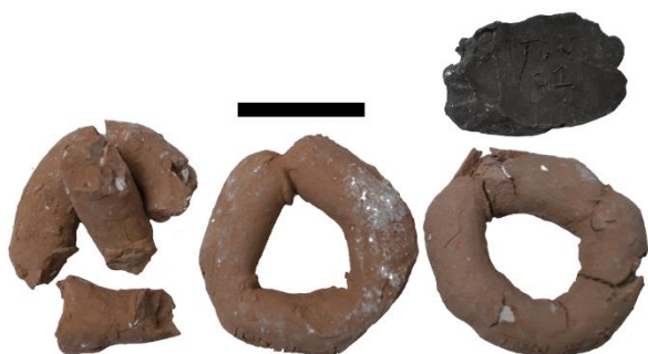
Figure III.73 : Argile crue de la Fm de Borgloon, Mb de Alden Biesen (haut), et colombins de l'échantillon Ton-01.a cuits en atmosphère oxydante à 700°C (gauche), 800°C (centre) et 900°C (droite). Echelle : 2 cm.
