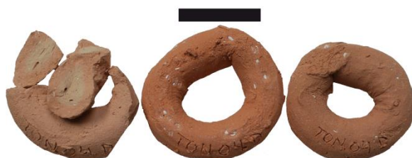
Figure III.83 : Colombins de l'échantillon Ton-04.a.D cuits en atmosphère oxydante à 700°C (gauche), 800°C (centre) et 900°C (droite). Echelle : 2 cm.
