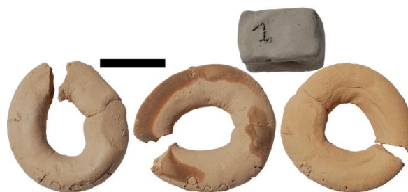
Figure III.126 : Argile crue de la Fm de Aachen (haut droite), et colombins de l'échantillon 123W0630 (n°1) cuits en atmosphère oxydante à 700 (gauche), 800 (centre) et 900°C (droite). Echelle : 2 cm.
