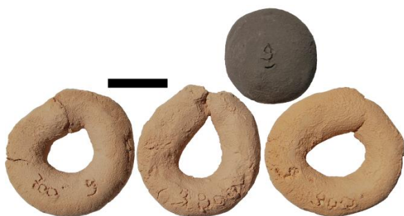
Figure III.124 : Argile crue de la Fm de Aachen (haut droite), et colombins de l'échantillon 123W0173 cuits en atmosphère oxydante à 700 (gauche), 800 (centre) et 900°C (droite). Echelle : 2 cm.
