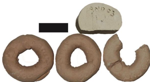
Figure III.102 : Argile crue « d'Andenne et du Condroz » (haut droite), et colombins de l'échantillon Vau-3.a cuits en atmosphère oxydante à 700°C (gauche), 800°C (centre) et 900°C (droite). Echelle : 2 cm.
