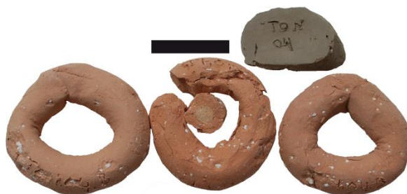
Figure III.82 : Argile crue de la Fm de Borgloon, Mb de Alden Biesen (haut droite), et colombins de l'échantillon Ton-04.a.B cuits en atmosphère oxydante à 700°C (gauche), 800°C (centre) et 900°C (droite). Echelle : 2 cm.
