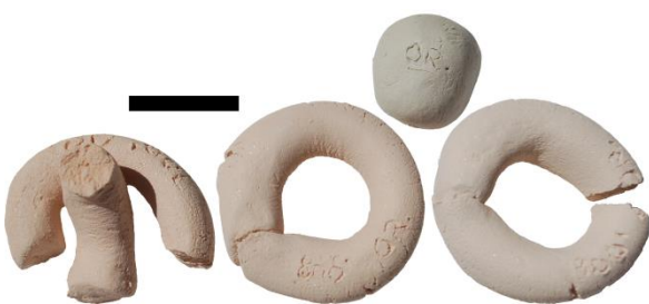
Figure III.114 : Argile crue de la Fm de l'Entre-Sambre-et-Meuse (haut droite), et colombins de l'échantillon Or--01.a, cuits en atmosphère oxydante à 700°C (gauche), 800°C (centre) et 900°C (droite). Echelle : 2 cm.
