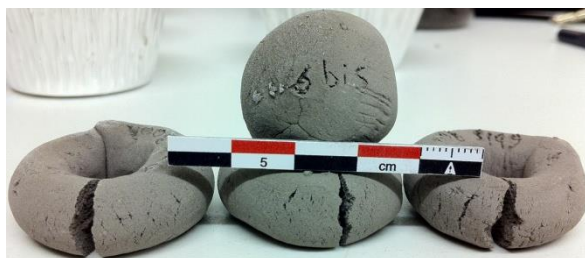
Figure III.132 : Argile crue de la Fm d'Aachen (haut droite), et colombrins de l'échantillon 123W0630 (n°7) cru après séchage.
