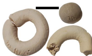
Figure III.121 : Argile crue de la Fm d'Aachen (haut droite), et colombrins de l'échantillon 123W0281b cuits en atmosphère oxydante à 800°C (gauche) 1 000°C (droite). Echelle : 2 cm.
