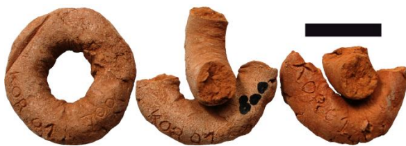
Figure III.94 : Colombins de l'échantillon Kor-01.a (Mb de Kortemark) cuits en atmosphère oxydante à 700°C (gauche), 800°C (centre) et 900°C (droite). Cet échantillon présente une légère couche blanchâtre de sels. Echelle : 2 cm.
