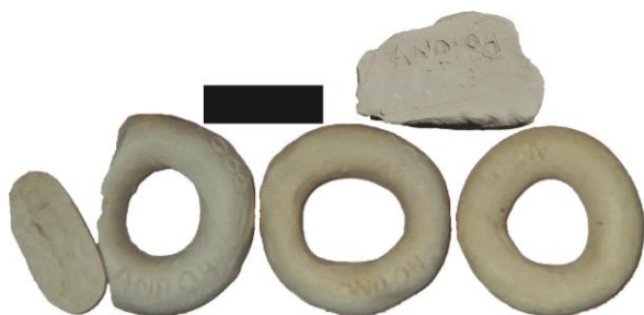
Figure III.104 : Argile crue « d'Andenne et du Condroz » (haut droite), et colombins de l'échantillon Vau-04.a cuits en atmosphère oxydante à 700°C (gauche), 800°C (centre) et 900°C (droite). Echelle : 2 cm.
