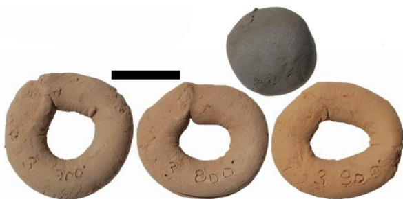
Figure III.127 : Argile crue de la Fm de Aachen (haut droite), et colombins de l'échantillon 123W0630 (n°3) cuits en atmosphère oxydante à 700 (gauche), 800 (centre) et 900°C (droite). Echelle : 2 cm.
