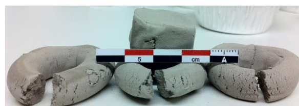
Figure III.125 : Argile crue de la Fm d'Aachen (haut droite), et colombins de l'échantillon 123W0630 (n°1) cru après séchage.
