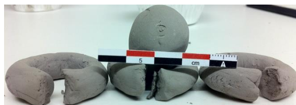
Figure III.130 : Argile crue de la Fm de Aachen (haut droite), et colombins de l'échantillon 123W0630 (n°6) cru après séchage.
