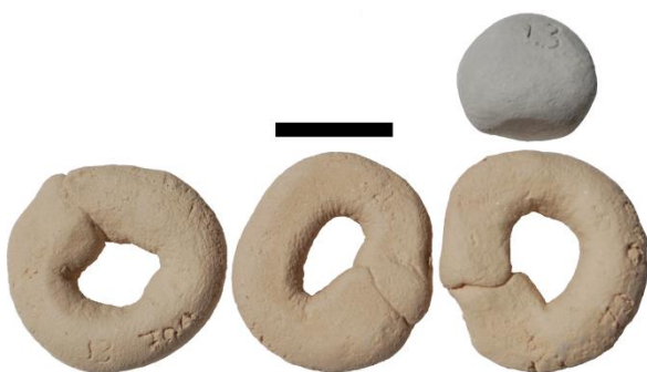
Figure III.120 : Argile crue de la Fm de Aachen (haut droite), et colombrins de l'échantillon 123W0704 cuits en atmosphère oxydante à 700°C (gauche), 800°C (centre) et 900°C (droite). Echelle : 2 cm.
