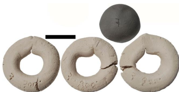
Figure III.135 : Argile crue de la Fm d'Aachen (haut droite), et colombrins de l'échantillon 123W0630 (n°8) cuits en atmosphère oxydante à 700 (gauche), 800 (centre) et 900°C (droite). Echelle : 2 cm.
