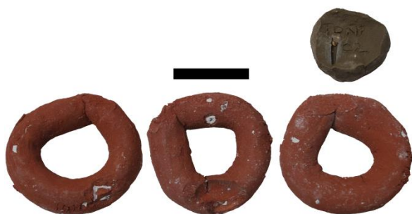
Figure III.74 : Argile crue de la Fm de Borgloon, Mb de Alden Biesen (haut), et colombins de l'échantillon Ton-02.a cuits en atmosphère oxydante à 700°C (gauche), 800°C (centre) et 900°C (droite). Echelle : 2 cm.
