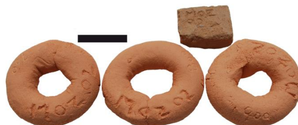
Figure III.107 : Argile crue « d'Andenne et du Condroz » (haut droite), et colombins de l'échantillon TR-02.a cuits en atmosphère oxydante à 700°C (gauche), 800°C (centre) et 900°C (droite). Echelle : 2 cm.
