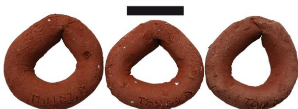
Figure III.80 : Colombins de l'échantillon Ton-02.a.D cuits en atmosphère oxydante à 700°C (gauche), 800°C (centre) et 900°C (droite). Echelle : 2 cm.
