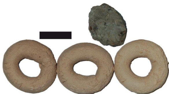
Figure III.103 : Argile crue « d'Andenne et du Condroz » (haut droite), et colombins de l'échantillon Blo-01.a cuits en atmosphère oxydante à 700°C (gauche), 800°C (centre) et 900°C (droite). Echelle : 2 cm.
