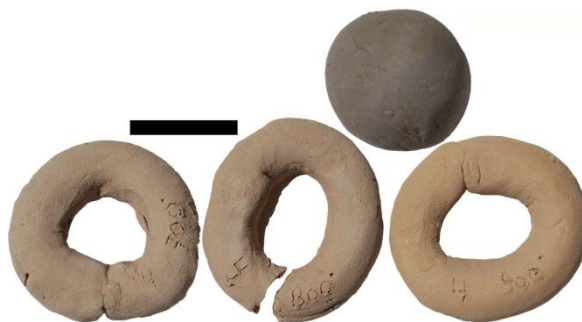
Figure III.129 : Argile crue de la Fm de Aachen (haut droite), et colombins de l'échantillon 123W0630 (n°4) cuits en atmosphère oxydante à 700 (gauche), 800 (centre) et 900°C (droite). Echelle : 2 cm.
