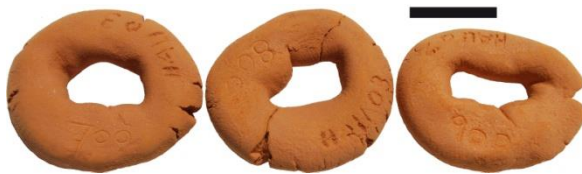
Figure III.138 : Colombins de l'échantillon Hau-03.a cuits en atmosphère oxydante à 700°C (gauche), 800°C (centre) et 900°C (droite). Echelle : 2 cm.
