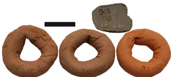
Figure III.61 : Argile crue de la Fm de Bilzen (haut droite), et colombrins de l'échantillon Bil-05.a cuits en atmosphère oxydante à 700°C (gauche), 800°C (centre) et 900°C (droite). Echelle : 2 cm.
