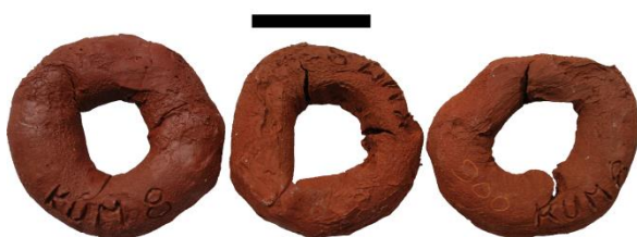
Figure III.68 : Colombins de l'échantillon Kum-08.a cuits en atmosphère oxydante à 700°C (gauche), 800°C (centre) et 900°C (droite). Echelle : 2 cm.
