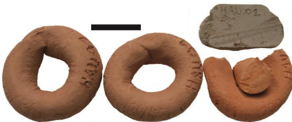
Figure III.137 : Argile crue d'altération d'Hautrage (haut droite), et colombins de l'échantillon Hau--01.a, cuits en atmosphère oxydante à 700°C (gauche), 800°C (centre) et 900°C (droite). Echelle : 2 cm.
