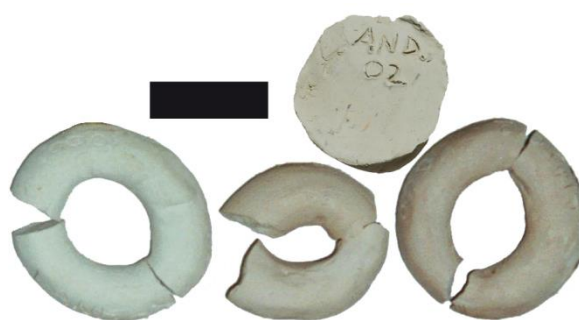
Figure III.101 : Argile crue « d'Andenne et du Condroz » (haut droite), et colombins de l'échantillon Vau-02.a cuits en atmosphère oxydante à 700°C (gauche), 800°C (centre) et 900°C (droite). Echelle : 2 cm.
