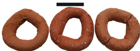
Figure III.81 : Colombins de l'échantillon Ton-03.a.B cuits en atmosphère oxydante à 700°C (gauche), 800°C (centre) et 900°C (droite). Echelle : 2 cm.
