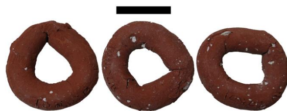
Figure III.79 : Colombins de l'échantillon Ton-02.a.B cuits en atmosphère oxydante à 700°C (gauche), 800°C (centre) et 900°C (droite). Echelle : 2 cm.
