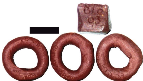
Figure III.105 : Argile crue « d'Andenne et du Condroz » (haut droite), et colombins de l'échantillon Blo-03.a cuits en atmosphère oxydante à 700°C (gauche), 800°C (centre) et 900°C (droite). Echelle : 2 cm.
