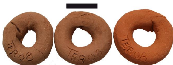
Figure III.53 : Argile crue de Boom, Fm de Boom, Mb de Terhagen (haut droite), et colombrins de l'échantillon Ter-08.a cuits en atmosphère oxydante à 700°C (gauche), 800°C (centre) et 900°C (droite). Echelle : 2 cm.
