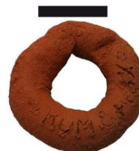
Figure III.69 : Colombin de l'échantillon Kum-08.a dégraissé avec 60%poids de quartz et cuit en atmosphère oxydante à 900°C. Echelle : 2 cm.
