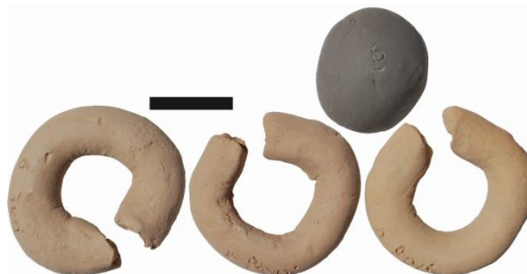
Figure III.131 : Argile crue de la Fm d'Aachen (haut droite), et colombins de l'échantillon 123W0630 (n°6) cuits en atmosphère oxydante à 700 (gauche), 800 (centre) et 900°C (droite). Echelle : 2 cm.
