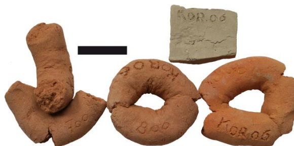
Figure III.93 : Argile crue du Membre de Kortemark (haut droite), et colombins de l'échantillon Kor-06.a cuits en atmosphère oxydante à 700°C (gauche), 800°C (centre) et 900°C (droite). Echelle : 2 cm.
