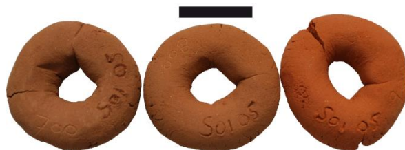
Figure III.145 : Colombins de l'échantillon Soi-05.a cuits en atmosphère oxydante à 700°C (gauche), 800°C (centre) et 900°C (droite). Echelle : 2 cm.
