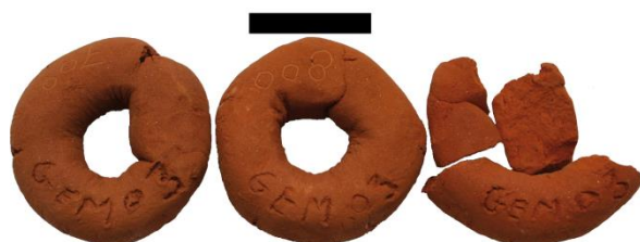
Figure III.144 : Colombins de l'échantillon Gem-03.a cuits en atmosphère oxydante à 700°C (gauche), 800°C (centre) et 900°C (droite). Echelle : 2 cm.
