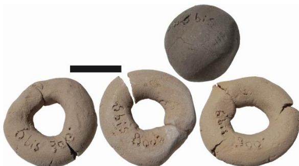
Figure III.133 : Argile crue de la Fm d'Aachen (haut droite), et colombrins de l'échantillon 123W0630 (n°7) cuits en atmosphère oxydante à 700 (gauche), 800 (centre) et 900°C (droite). Echelle : 2 cm.
