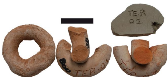
Figure III.56 : Argile crue de Boom, Fm de Boom, Mb de Terhagen (haut droite), et colombins de l'échantillon Ter-01 .a cuits en atmosphère oxydante à 700°C (gauche), 800°C (centre) et 900°C (droite). Cet échantillon illustre bien les problèmes d'efflorescences blanches. Echelle : 2 cm.
