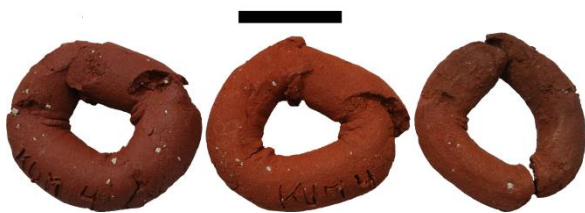
Figure III.67 : Colombins de l'échantillon Kum-04.a cuits en atmosphère oxydante à 700°C (gauche), 800°C (centre) et 900°C (droite). Échantillon présentant des points de chaux. Echelle : 2 cm.
