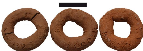
Figure III.95 : Colombins de l'échantillon Kor-02.a.D (Mb d'Aalbeke) cuits en atmosphère oxydante à 700°C (gauche), 800°C (centre) et 900°C (droite). Echelle : 2 cm.
