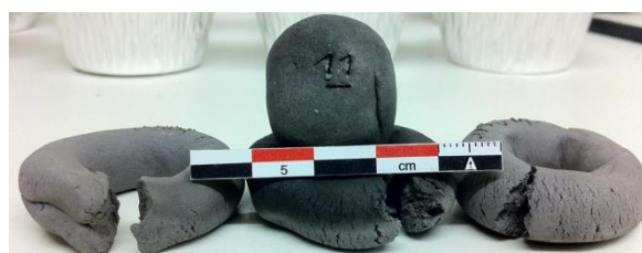
Figure III.122 : Argile crue de la Fm de Aachen (haut droite), et colombrins de l'échantillon 123W0287d cru après séchage.
