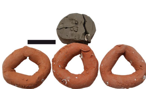
Figure III.75 : Argile crue de la Fm de Borgloon, Mb de Alden Biesen (haut), et colombins de l'échantillon Ton-03.a cuits en atmosphère oxydante à 700°C (gauche), 800°C (centre) et 900°C (droite). Echelle : 2 cm.
