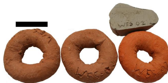
Figure III.49 : Argile crue de Westmalle, de la Fm de Herzele (haut droite), et colombins de l'échantillon Wes-02.a cuits en atmosphère oxydante à 700°C (gauche), 800°C (centre) et 900°C (droite). Echelle : 2 cm.
