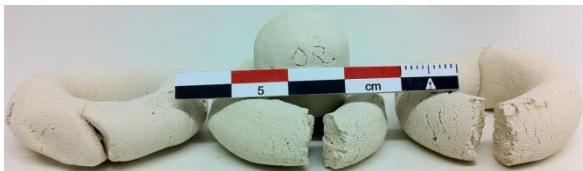
Figure III.113 : Argile crue de la Fm de l'Entre-Sambre-et-Meuse (haut droite), et colombins de l'échantillon Or-01.a cru après séchage.
