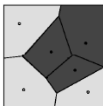
Figure 2.7 – Formalisme de distribution de matière : diagramme de Voronoï avec en gris clair le matériau A et en gris foncé le matériau B (Source [17])
