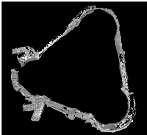
Fig. 2 – Vista dall'alto del modello tridimensionale della “sala triabsidata”. Le lacune presenti sul modello sono dovute alla presenza di elementi di sostegno in legno posti all'esterno della struttura.
